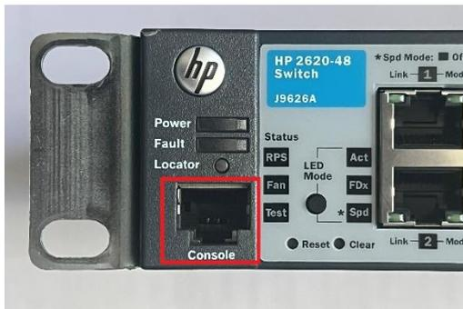
Le port console est situé dans le carré rouge. Sur ce modèle HP, le port console est situé à gauche avec une connectique RJ45.
